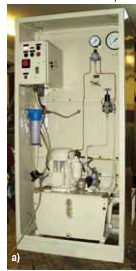
Рис. 4. Гидрооборудование с масляно-водяной мультипликацией производства НПП «ЭНИМС-Интергидропривод»:
