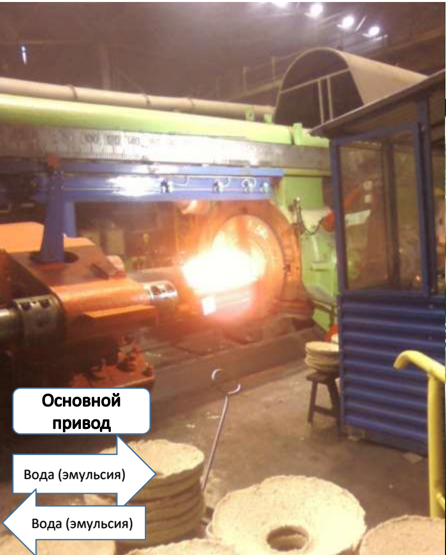
Подача заготовки в контейнер горизонтального профильного прессы модели П8148 усилием 63 МН (ПАО «Металлургический завод «Электросталь»)
