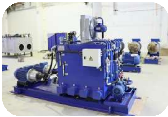
Насосная станция управления агрегата продольной резки. Северсталь
