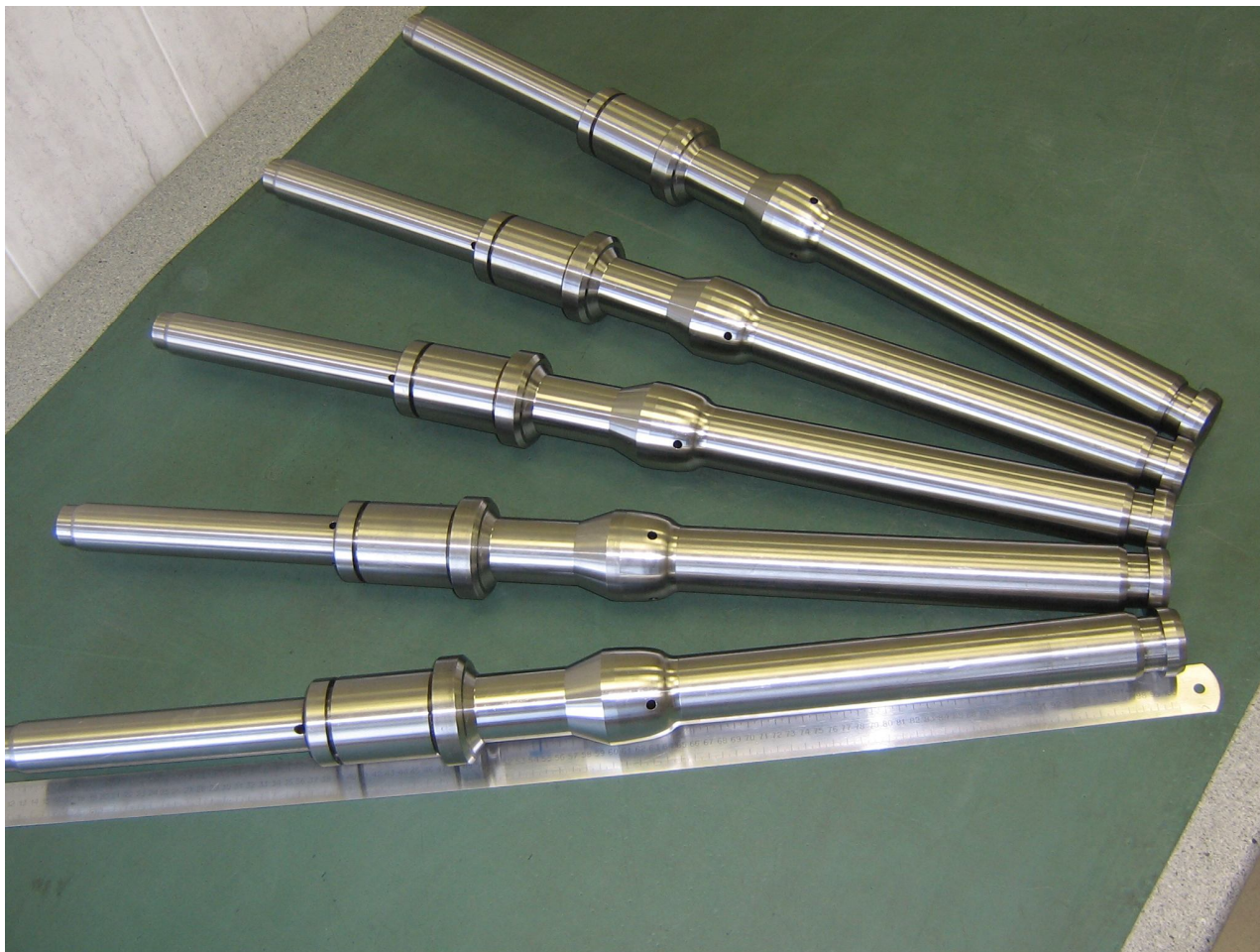
Рис. 4. Комплект запорно-регулирующих элементов для напорных клапанов гидрораспределителей рабочих гидроцилиндров пресса НП-130
