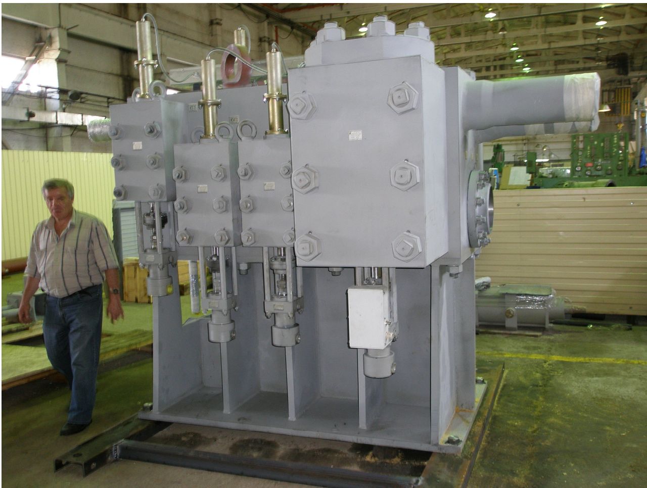
Рис. 6. Главный гидрораспределитель для модернизированной электрогидравлической системы управления прессы № 1-4657.00 на участке отгрузки готовой продукции ООО “УриЦ”
