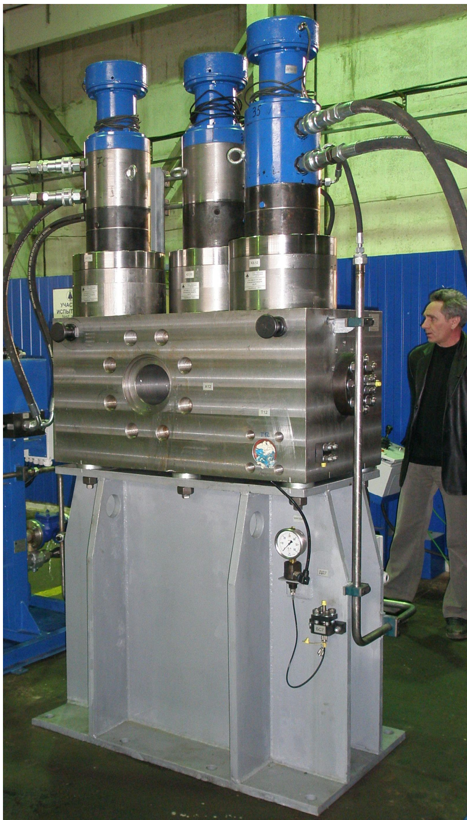
Рис. 8. Главный гидрораспределитель для модернизированной электрогидравлической системы управления прессы П8148 на участке испытаний готовой продукции ООО «УриЦ»
