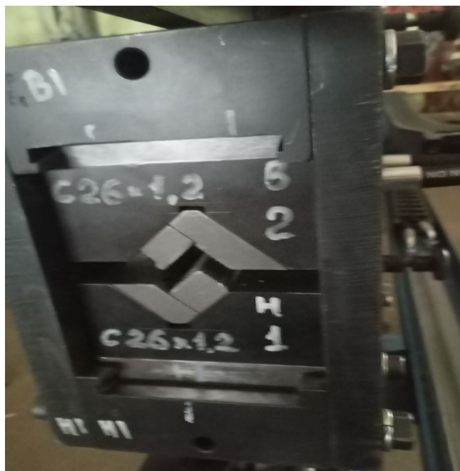
Рисунок 3. Зажимные губки УППР-1 для Z-образного профиля
