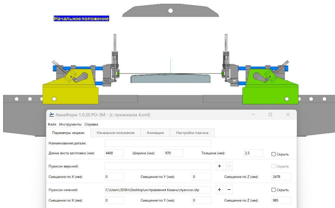
Рисунок 6. Начальное положение обтяжного пуансона и листовой заготовки
