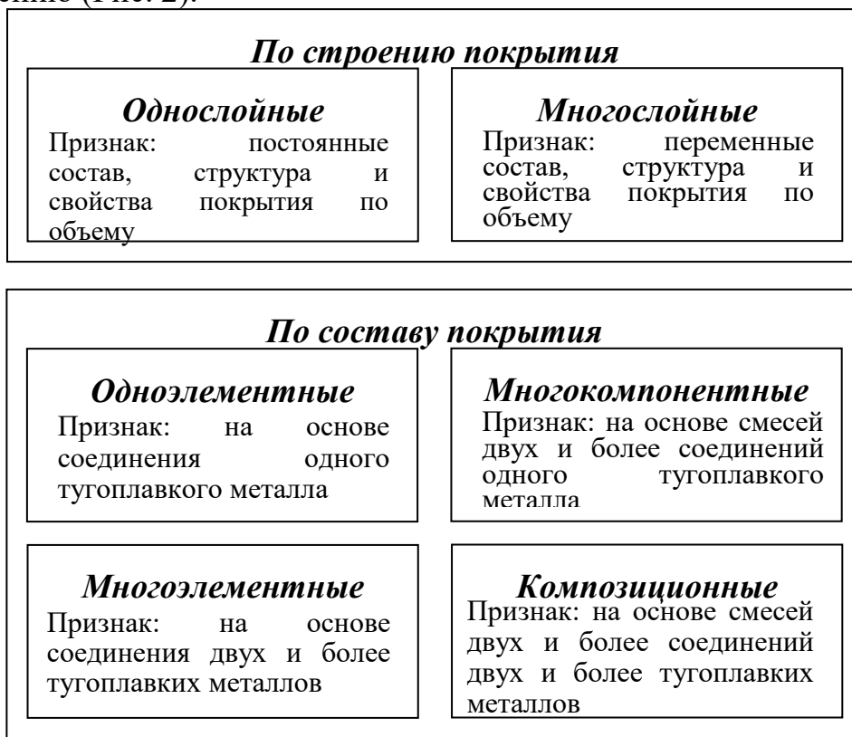
Рисунок 2. Обобщенная классификация износостойких покрытий для инструмента
