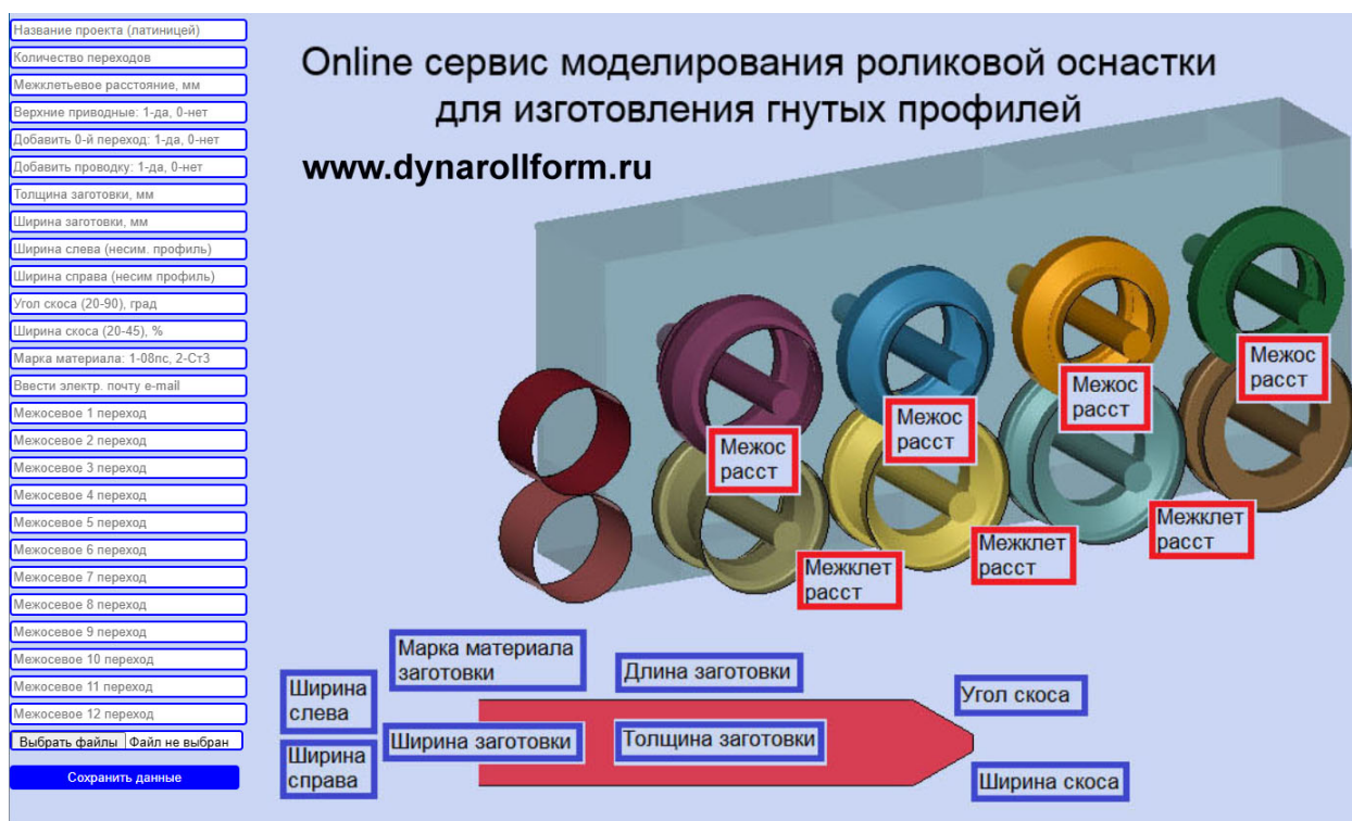
Рисунок 8. Online сервис для моделирования роликовой оснастки https://www.dynarollform.ru
