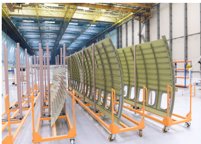
Рисунок 1. Панель фюзеляжа летательного самолета МС-21 с Z-образными гнутыми профилями
