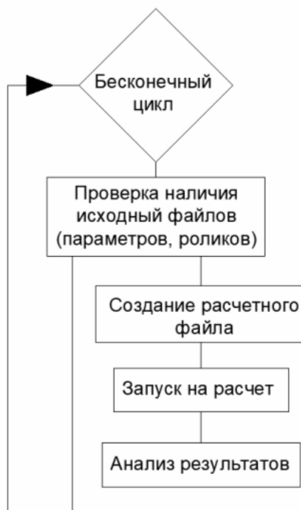
Рисунок 9. Укрепленный алгоритм работы программы DynaRollForm
