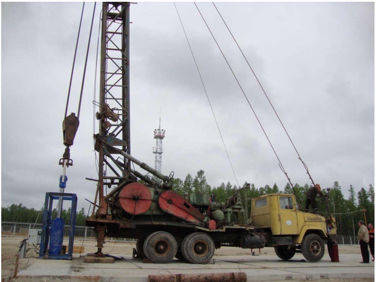
Стенд испытательный усилием 200 тс
