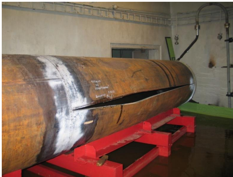
Рис. 5. Разрыв трубы после испытаний.
