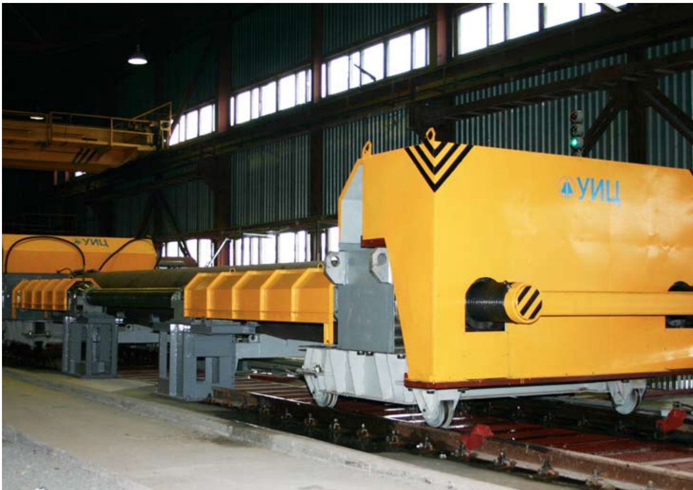
Рис. 1. Стенд для гидравлических испытаний труб (ОАО «Копейский завод изоляции труб»)
