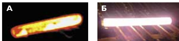
РИС. 5. Фото трубной заготовки с окалиной и после процедуры гидросбива. А — заготовка с окалиной; Б — заготовка после гидросбива
