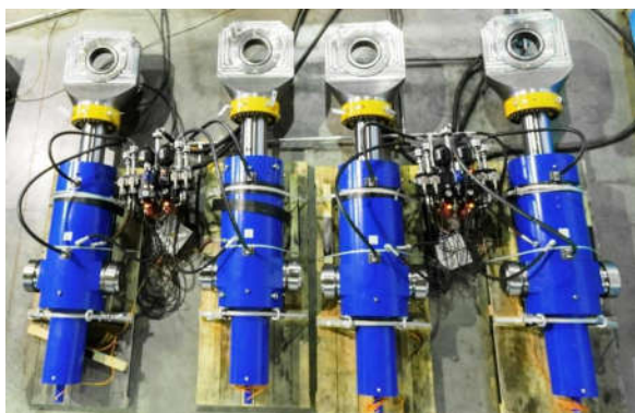
Рис. 2. Нагружающие гидроцилиндры на участке испытаний готовой продукции ООО «Уральский инжиниринговый центр»
