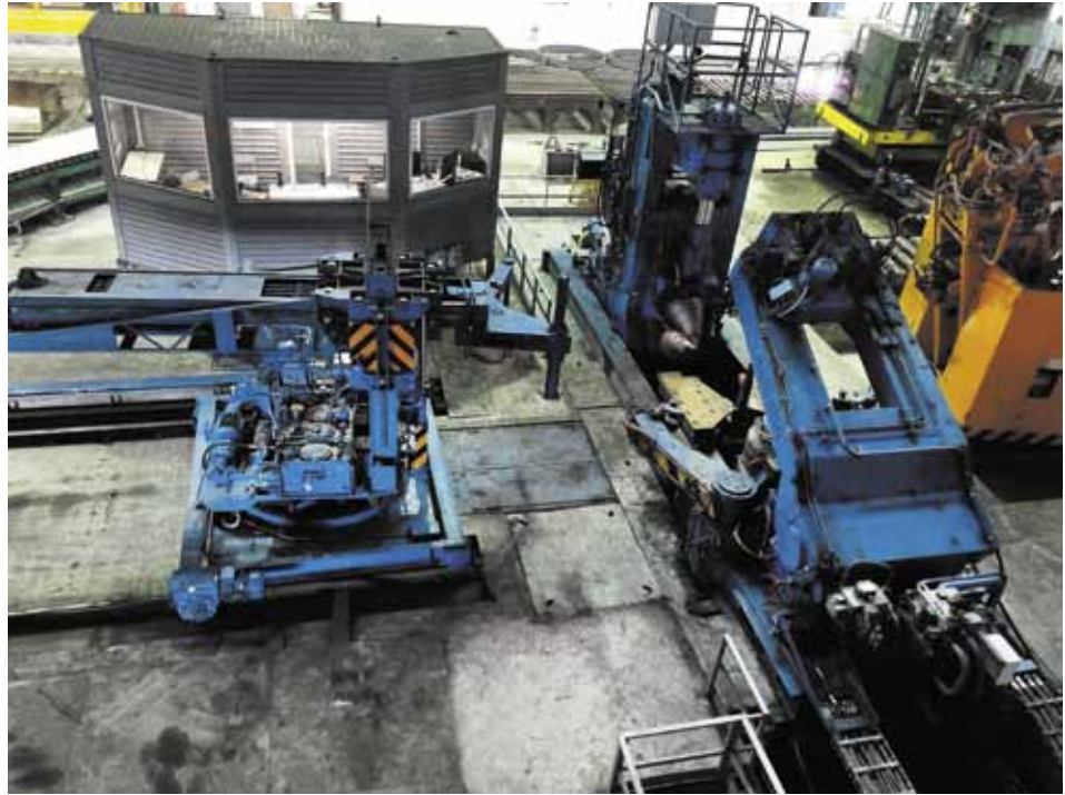
РИС. 1. Созданный кольцераскатный стан на ОАО "Русполимет" (г. Кулебаки)
